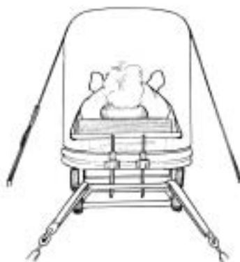
図 アイソレータをヘリコプター内に搬入した状態。ここではベルトにより固定されている。
